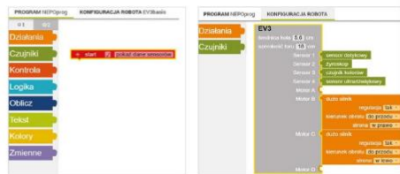
Rys. 11.10. Obszar roboczy Open Roberta Lab i konfiguracja robota EV3
